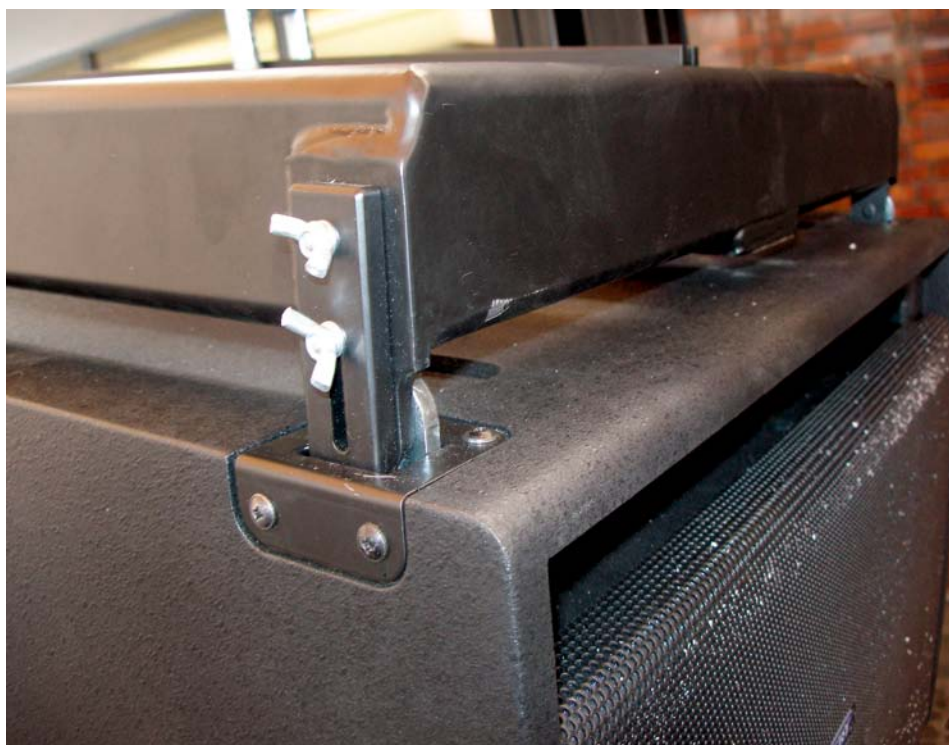
Najwięcej problemu przysparza zamontowanie modułu basowego 212FSA do ramy (dość ciężkiej).
