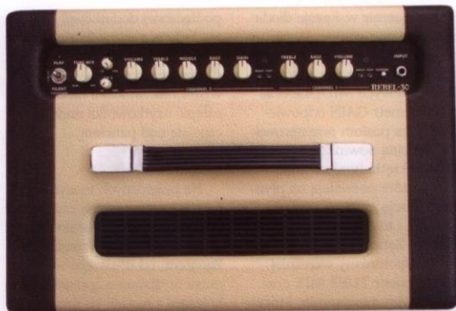
Gałki potencjometrów, przełączniki i gniazdo wejściowe to elementy, które umieszczono we wnęce zlokalizowanej na płycie górnej urządzenia, dzięki czemu są one odpowiednio chronione podczas transportu.
